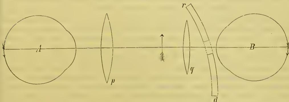
aus dem Auge A Fig. 46 parallel oder schwach convergirend heraus, und ich bringe vor dasselbe eine Sammellinse  $p$ , so werden die Strahlen zusammengebrochen werden und es wird von dem Netzhautbilde ein umgekehrtes Luftbild (siehe den Pfeil) entworfen werden. Dieses sehe ich durch eine Sammellinse  $q$
